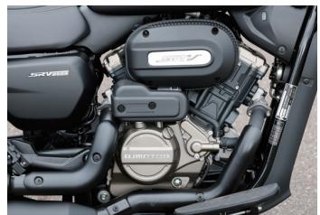
エンジンはベースのSRV250と同じく水冷のSOHCVゾイン。パワーは20.5kW(約27.8PS)と、このクラスのクルーザーとしては強力。これにAMTミッションを組み合わせる。
