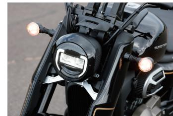
センターに角形の3連LEDユニットを配し、左右にポジションランプをレイアウトしたユニークなヘッドライトユニット。前後のウインカーはオーソドックスな丸形形状のLEDだ。
