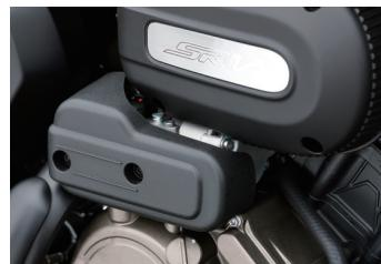
AMTは既存のマニュアル6速ミッションにアクチュエーターを組み合わせ、発進、変速、停止までのクランチの断続を自動制御するもの。アクチュエーターは非常にコンパクト。
