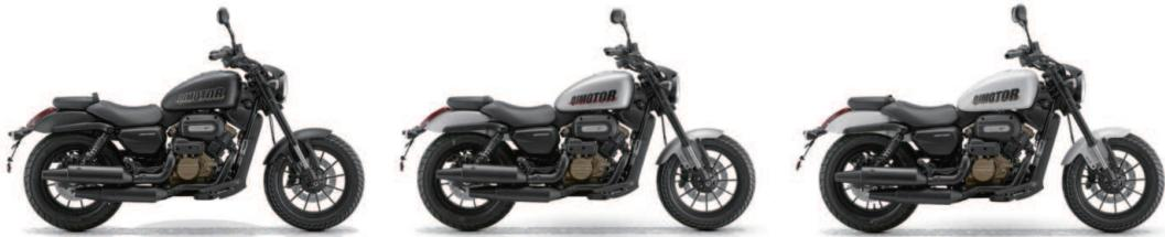
AMTはSRV250の6速マニュアルミッションをベースに、クラッチの断続とシフトのアップ／ダウンを自動化したもの。クッチャレバーを持たないのでAT限定免許で乗れ、シフトペダルもない。リアブレーキはハンドル左側のレバー操作なので、足はステップに乗せているだけでいい。操縦感覚はスクーターとほぼ同じだ。
