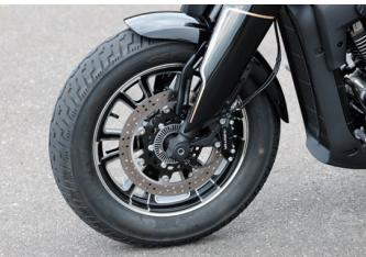
美しい切削加工が施されたホイールを採用。フロントフォークは倒立で、ブレーキキャリバーは4ポットと、スポーティな構成となる。タイヤはCST製の16インチ。
