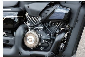
Vツインエンジンは水冷の385cc・DOHC4バルブで、最高出力は34PS。トルクが非常に豊かな仕様で、振動も控えめでスムーズ。滑らかなフィーリングが高級感を醸し出す。
