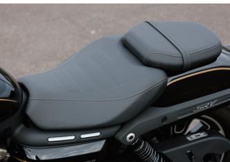
シート形状はホールド性の高いもので、タンデムシートは小ぶりながら座面を広めにとったフラットなもの採用。タンデムシート前端にはQJモーターのロゴも入る。
