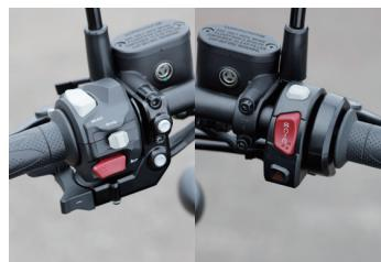
左スイッチボックスにはD/Mモード切り替えボタンやシフトアップ/ダウンスイッチを装備。右スイッチボックスにはハザードスイッチやトラコンのスイッチが備わる。
