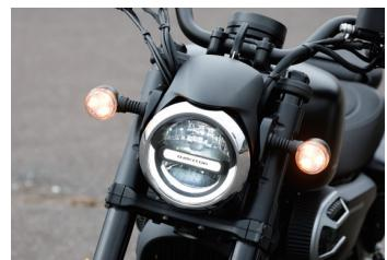
中央にQJモーターのロゴをあしらったブリッジを持つ、丸目のヘッドライトはLED式。左右のLEDウインカーは丸型のクリアレンズを採用したクラシカルなフォルム。
