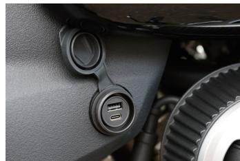
車体左側、タンク下にはUSB電源ポートを2連で装備。上段がUSB-A、下段がUSB-Cタイプで、防水キヤップも完備。スマートフォンなどアクセサリへの電源供給に便利だ。
