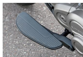
チェンジペダルとリアブレーキペダルを持たないため、フットボード式を採用する左右のステップは広々としたもの。足を置くスペースの自由度も高い。
