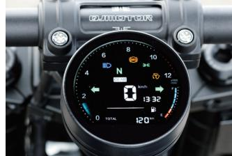
メーターはカラー表示のLCD。丸形1眼タイプだが、スピードのほかにタコメーター、ギアポジション、燃料計、トリップなどを表示可能で、非常に多機能な仕様となっている。
