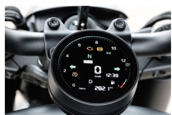
円形ナセルに収まるカラーLCDメーターは機能も多彩。スピード、タコ表示のほか、トラコンやAMTの変速モード、ギアポジション、燃料計などを表示可能。
